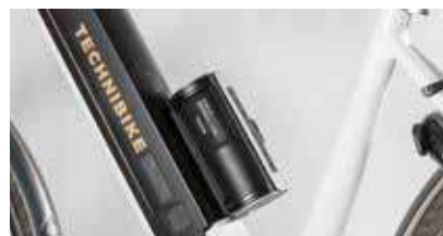
Montage an der Getränkehaltervorrichtung
